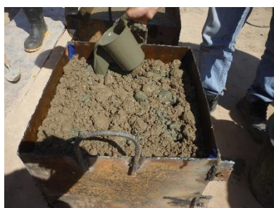
Placing GE-RCC (Method 2)
