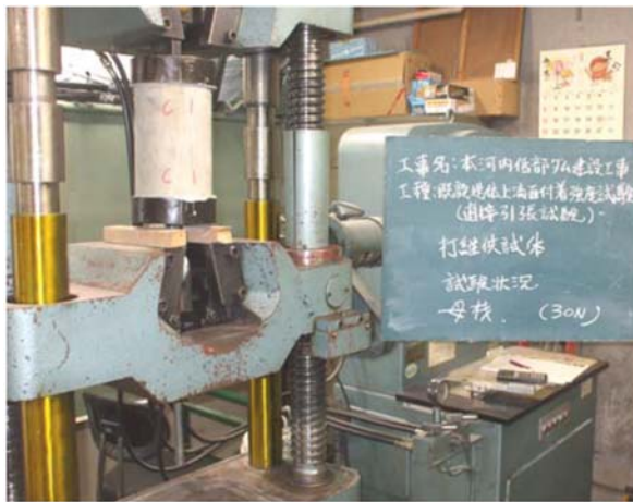
Fig. 5 Adhesion Strength Test (Direct Tensile Test) Essai d'adhérence (Essai de traction directe)
