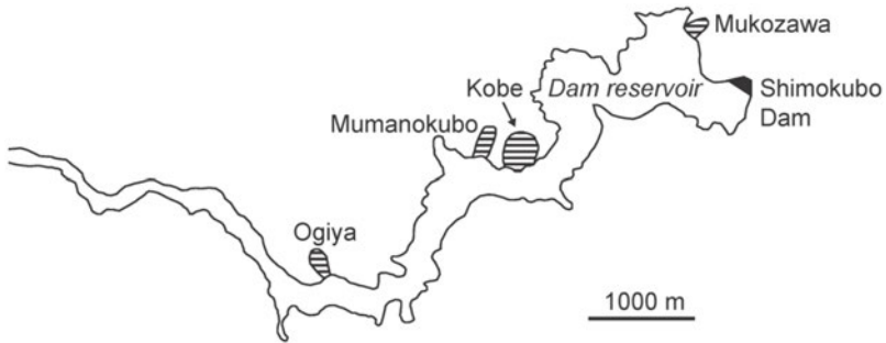
Fig. 5 Distribution of reservoir landslides at the Shimokubo Dam. Based on TAMADA [3]. Répartition des glissements de terrain dans le réservoir du barrage de Shimokubo. Basé sur TAMADA [3].
