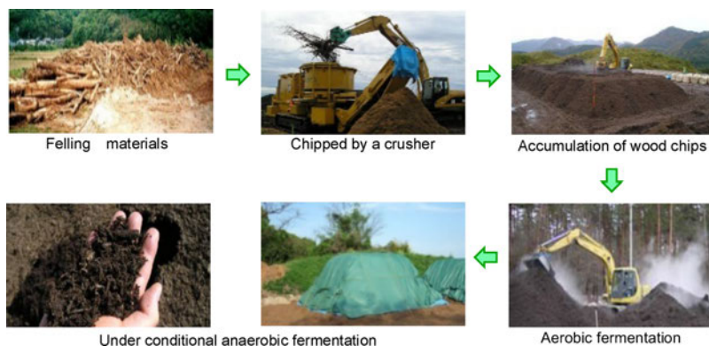
Fig. 7 Production process of wood chips compost Processus de production du compost de copeaux de bois
